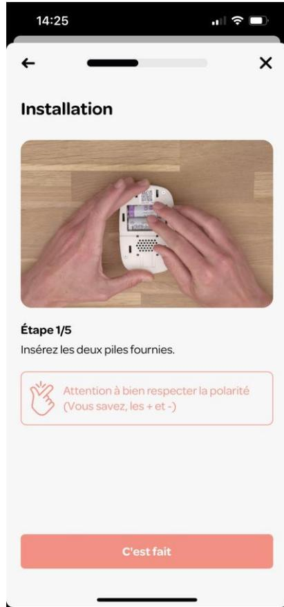
Insérez les piles dans le Check'In en respectant bien la polarité
