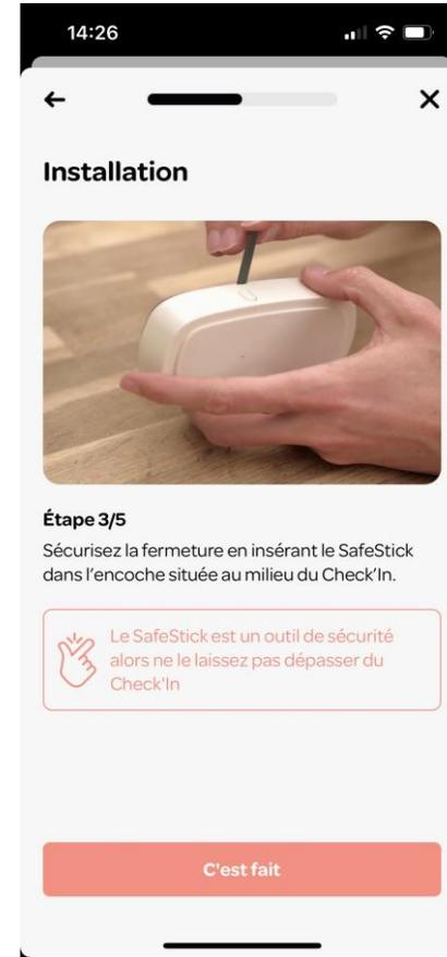
Insérez le SafeStick pour sécuriser la fermeture
